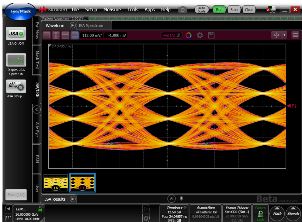
图 10. N107 针对 NRZ（上）信号和 PAM4（下）信号提供时钟恢复功能。
